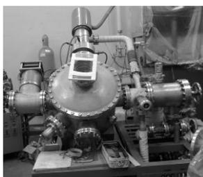
図7 低エネルギー電子線照射装置（100keV）
