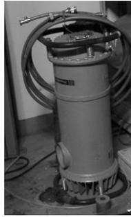
図9 X線非破壊検査装置
