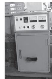
図8 X線照射装置
