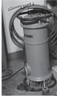
図9 X線非破壊検査装置
