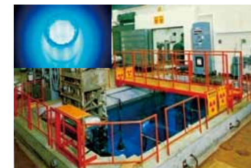
ガンマ線照射のための水プール施設とコバルト60線源から放出されるチェレンコフ光
