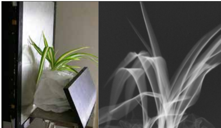
図3 中性子線による水分像（オリズラン） 左：照射ターゲット、右：水分像（白い所ほど水分量が多い）
